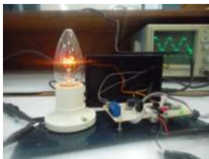
Gambar 4 Pengujian zero crossing detector menggunakan osciloskop
