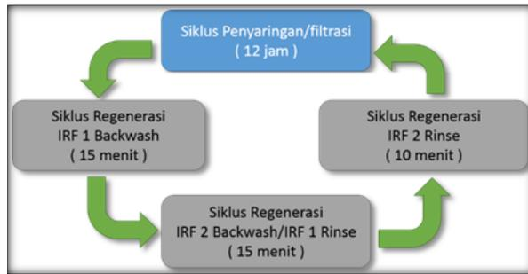
Gambar 9. Diagram siklus dan durasi operasi IRF.
