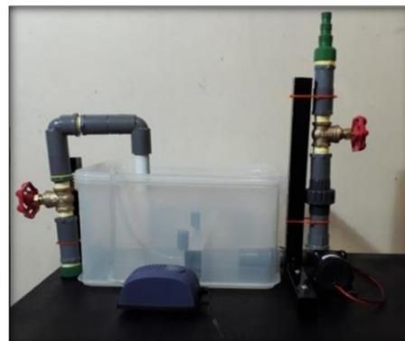
Gambar 16. Rangkaian unit *aerator*, *blower*, dan pompa *filter*.
