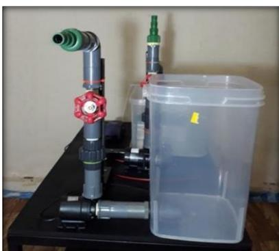
Gambar 18. Rangkaian tangki dan pompa *supply*.
