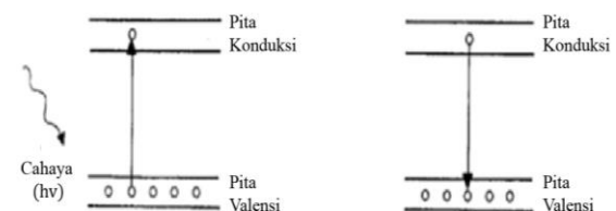
Gambar 2. Proses eksitasi dan de-eksitasi elektron pada fotodiode [11].
