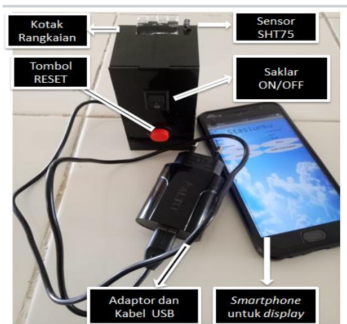
Gambar 7. Rancangan alat ukur suhu dan kelembaban udara.
