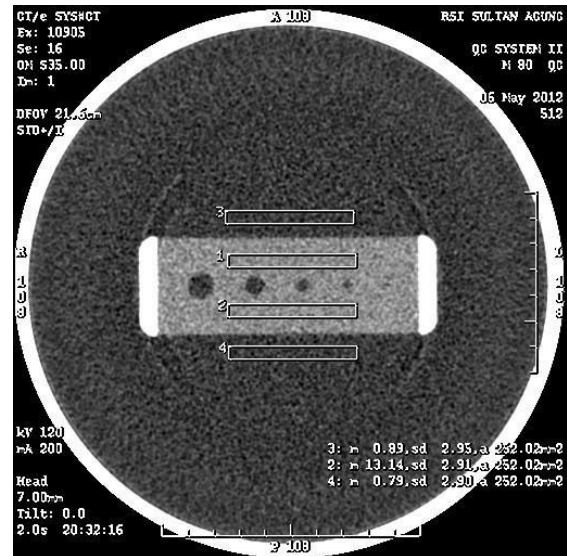
Gambar 2. Posisi ROI untuk pengukuran resolusi kontras citra. Terdapat 2 ROI di dalam kotak polystyrene dan 2 ROI di air di luar kotak polystyrene . ROI berbentuk persegi.
