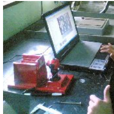
Gambar 3. Rancangan dan alat pengambil citra digital untuk kontruksi batuan 3D.
