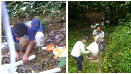
Gambar 2. Pembuatan core sample dan pengambilan sampel tanah longsor untuk pengukuran permeabilitas di laboratorium
