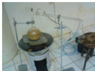
Gambar 2 Penyulingan dengan tungku sekam
