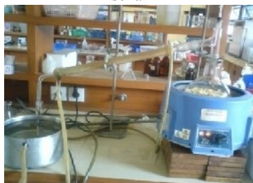
Gambar 3. Penyulingan dengan heating mantel
