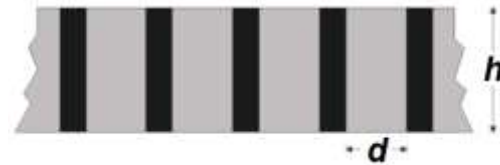
Gambar 1. Ilustrasi grid dengan ketebalan lempeng timbal h dan jarak antara timbal d . Rasio grid dihitung sebagai perbandingan antara h dan d .
