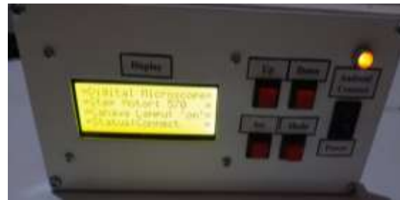
Gambar 13. Posisi jumlah pergerakan motor langkah akan tampil pada layar LCD display panel.
