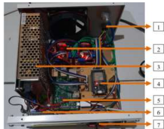
Gambar 11. Panel sistem kendali mikroskop digital. Panel tersebut terdiri dari komponen berikut: 1. Soket motor langkah dan soket USB kamera, 2 Modul driver motor langkah IC L298N, 3. Power Supply 5V / 20 Ampere, 4. Mikrokontroler ESP32, 5. Raspberry Pi 3 Model B, 6. Penampil LCD 4x20 dan I2C LCD, dan 7. Tombol pengaturan panel.
