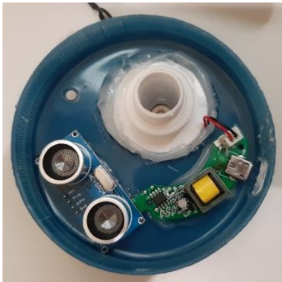
Gambar 9. Penempatan HC-SR04 dan modul humidifier pada tutup alat
