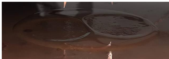
Gambar 5. Lubang pada minyak silikon dibawah elektroda aktif dengan menggunakan elektroda Dua Pisau Corona Discharge.
