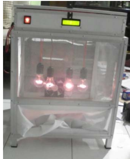
Gambar 2. Sangkar nyamuk yang dilengkapi dengan pemanas dan sensor suhu
