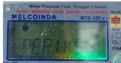
**Gambar 9.** Tampilan pada kWh meter PLN ketika terjadi kebocoran arus
