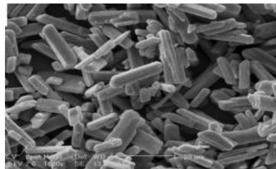
Gambar 5. Fitur Morfologi ZnO Modified Metal Organic Frameworks (Mofs) dipelajari melalui teknik SEM pada ketebalan 20µm dengan perbesaran 1000x.
