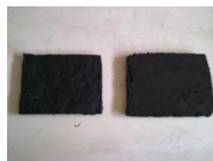
Gambar 4. Hasil fabrikasi elektroda karbon aktif berukuran  $8 \times 6 \times 0,3 \text{ cm}^3$
