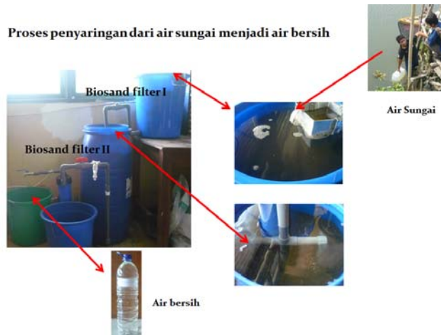
Gambar 6. Proses pengolahan air sungai menjadi air bersih melalui biosand filter.
