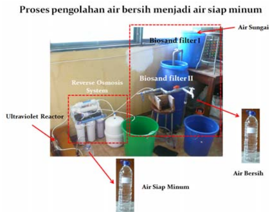
Gambar 7. Proses pengolahan air bersih menjadi air siap minum melalui Reverse osmosis dan reaktor Ultraviolet.
