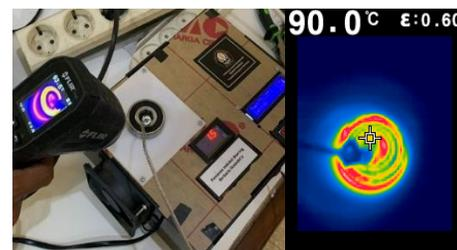
**Gambar 7.** Pengecekan suhu *bearing* 15 menggunakan *thermogun*.
