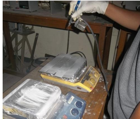
Gambar 1. Proses pembuatan lapisan ZnO:Ag 4%
