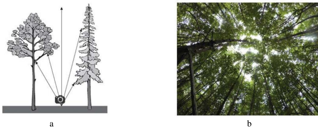
Gambar 4. (a) Ilustrasi metode hemispherical photography untuk mengukur tutupan mangrove (Jenning et al. , 1999; Korhonen et al. , 2006) (b) hasil pemotretan dengan lensa fisheye secara vertikal.
