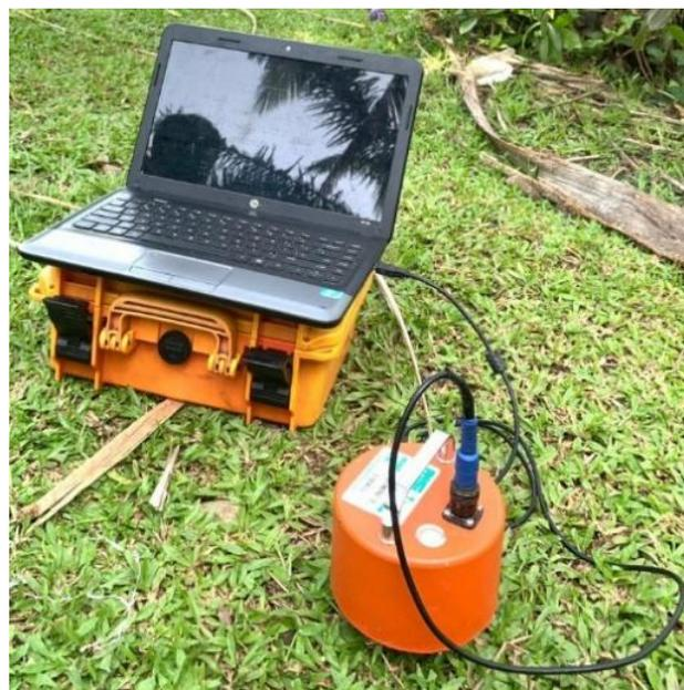
**Gambar 1.** Seismometer *Portable Short Period* yang terdiri dari Seismometer PASI Mod Gemini 2 Sn 1405 dan laptop digitizer.
