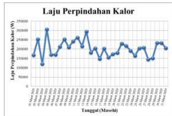
Gambar 2. Laju perpindahan kalor CNG Cooler
