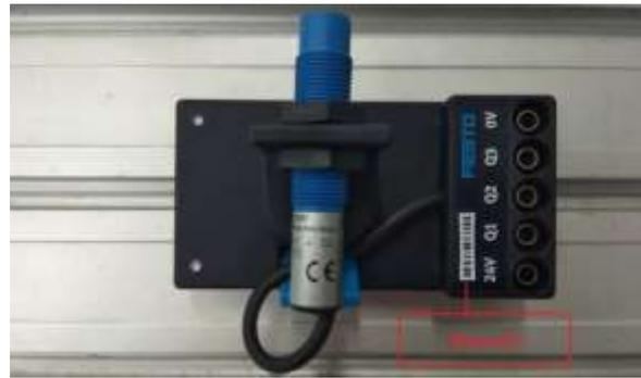
Gambar 6. *Proximity Switch (Capacitive)* yang telah ditambahkan *barcode*
