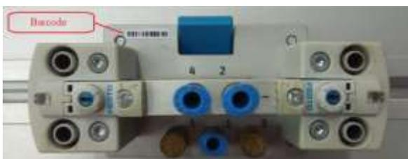
Gambar 5. *5/2 Way Double Solenoid Valve* yang telah ditambahkan *barcode*
