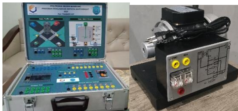
Gambar 9. Bentuk fisik Portable PLC Trainer Kit dan Motor AC
