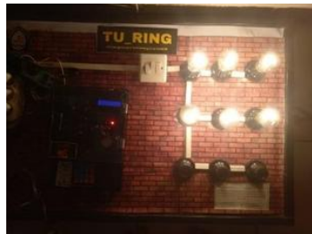
Gambar 11. Percobaan tarif 900 VA Subsidi dan RTM dengan 6 buah Lampu Pijar Menyala
