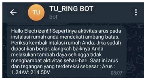
Gambar 10. Telegram Mengirimkan Notifikasi Pesan pada Percobaan Tarif 450 VA
