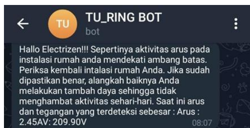
Gambar 12. Telegram Mengirimkan Notifikasi Pesan pada Percobaan Tarif 900 VA Subsidi dan RTM
