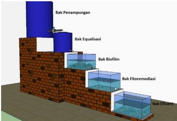
**Gambar 3.** Rancangan Prototype Bioreaktor
