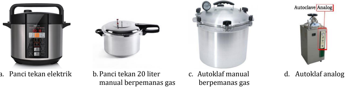
Gambar 1. Beberapa jenis autoklaf tipe kecil; a. panci tekan elektrik yang bisa dimanfaatkan sebagai autoklaf, b. panci tekan manual yang dipanaskan di atas kompor gas, c. autoklaf manual kapasitas lebih besar yang dipanaskan di atas kompor (ada juga versi elektriknya), d. autoklaf analog dengan pemanas listrik yang dapat diprogram (gambar tidak berskala).
