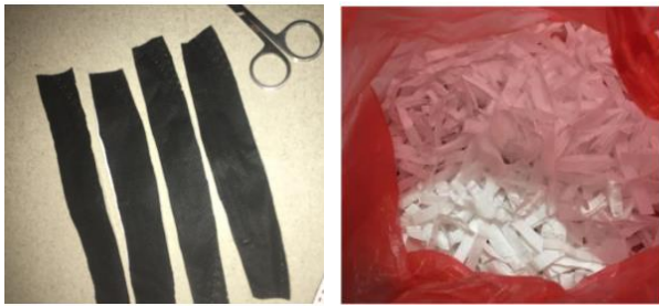
Filler limbah masker panjang Filler limbah masker pendek Gambar 1. Filler Limbah Masker Nonmedis KF94
