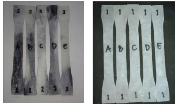
Spesimen Filler panjang Spesimen Filler Pendek Gambar 2. Spesimen Pengujia Kekuatan Tarik
