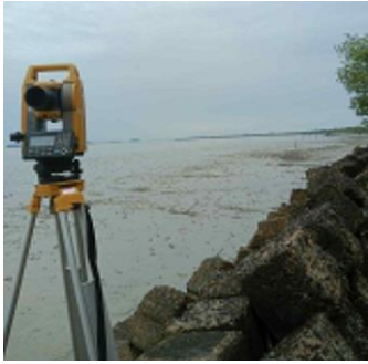
Gambar 2. Alat Total Station Pada Pengukuran Bathimetri Sumber: Dokumentasi Pribadi, 2023
