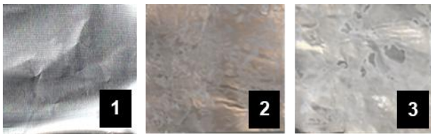
Gambar 3. Foto Penampakan (1) Aluminium Foil dan Foil LDH dengan Perlakuan Rendaman Menggunakan Larutan (2) MgCl_2 , (3) Mg(NO_3)_2
