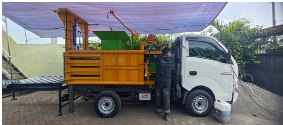
Gambar 2. Prototipe Mesin Hidrolik Pengepres Sampah Mobile
