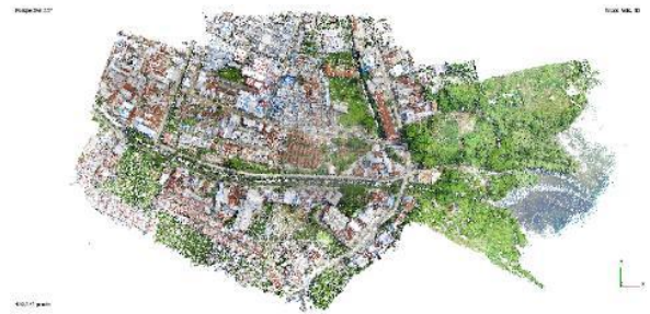
Gambar 5. Hasil Pembuatan Point Cloud dari Data Fotogrametri
