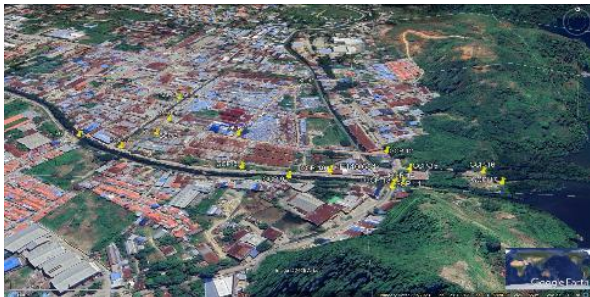
Gambar 4. Desain Survei 17 Titik Kontrol Koordinat di Permukaan (GCP)
