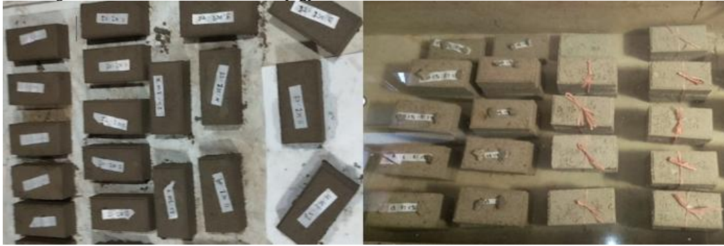
Gambar 3. Hasil Pencetakan dan Curing Paving Block dengan Menggunakan Campuran Plastik PET dan Fly Ash
