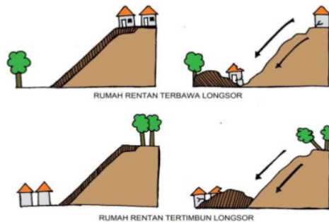
Gambar 6. Ilustrasi perbedaan rumah rentan terbawa dan tertimbun longsor
