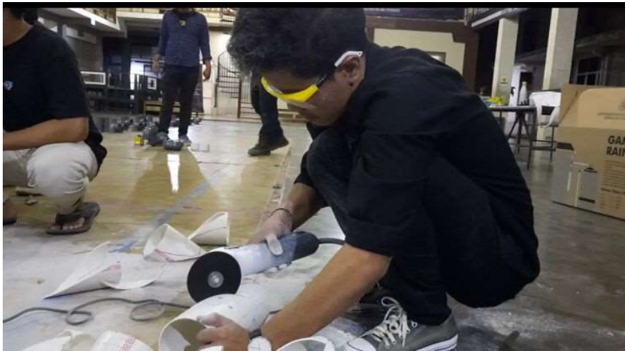
Gambar 5.4 Kegiatan Penyiapan Komponen dari Alat Injeksi Air Hujan
