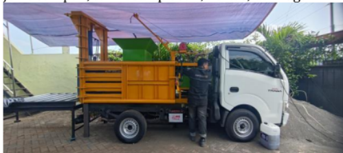
Gambar 2. Prototipe Mesin Hidrolik Pengepres Sampah Mobile
