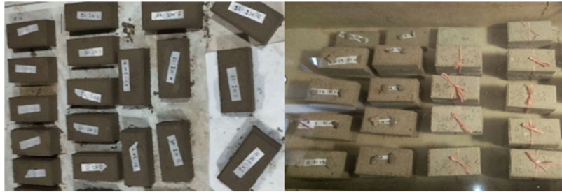
Gambar 3. Hasil Pencetakan dan Curing Paving Block dengan Menggunakan Campuran Plastik PET dan Fly Ash
