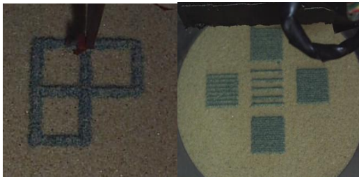
Gambar 13. Deposisi serbuk produk diantara supporting powder
