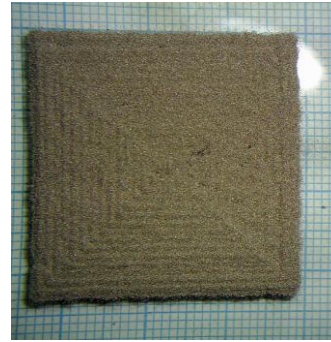
Gambar 10. Penggunaan nilai scanning gap yang kecil menghasilkan deposisi serbuk yang lebih padat dibandingkan dengan penggunaan scanning gap yang lebih besar
