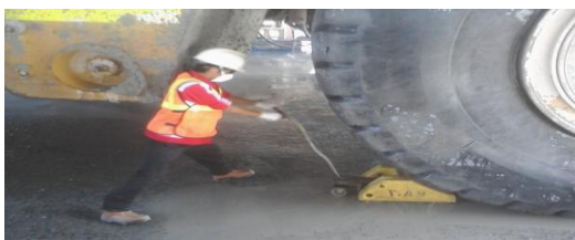
Gambar 1 Pemakaian Alat Bantu Kerja Wheel chock
