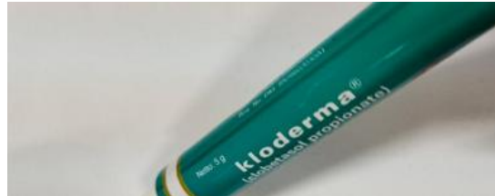
Gambar 10. Cacat Tinta Tergores
