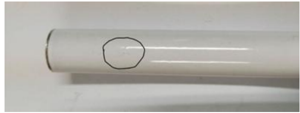
Gambar 3. Cacat Bercak dan Gelembung
