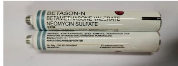
Gambar 9. Cacat Warna Tidak Solid
