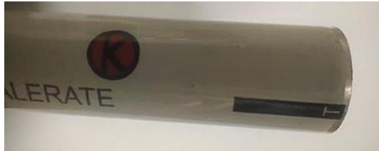
Gambar 8. Cacat Bercak Kotoran Gram
