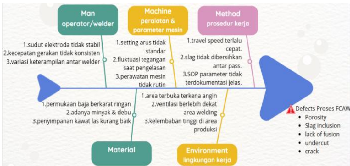
Gambar 2. Diagram Fishbone Penyebab Cacat FCAW
