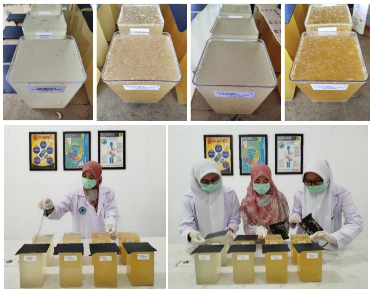
Gambar 4. Proses Bioremediasi Limbah Cair dengan Eco Enzim Sumber: Dokumentasi Penelitian, 2025
