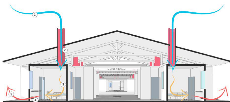
Gambar 2.3: Skema aliran udara Rumah Sakit (12)
