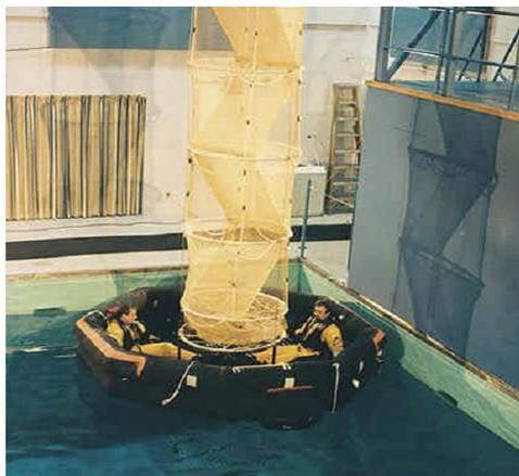
Gambar 11. Skyscape sistem dengan menggunakan Chute
