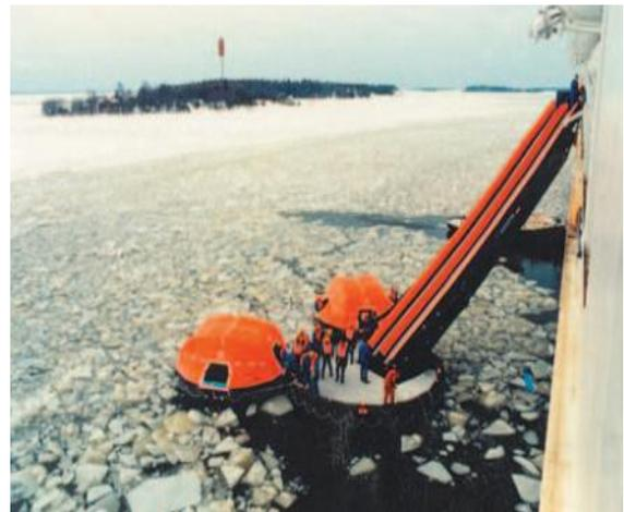
Gambar 12. Skyscape sistem dengan menggunakan Slide
