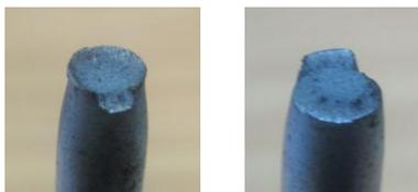
Gambar 7 Bentuk patahan uji tarik baja ST 60
