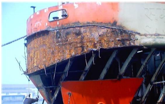
Gambar.1. Pengelasan plat baja kulit kapal
