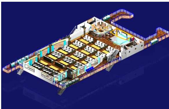
Gambar 4 Gambar 3D bangunan atas kapal setelah diredesain
