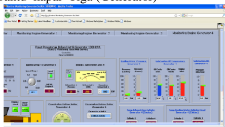
Gambar 20 Kontrol monitoring simulasi mesin bantu kapal Empat (Generator)
