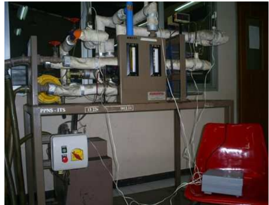
Gambar 14. Perangkat interface dan penempatan sensor temperatur
