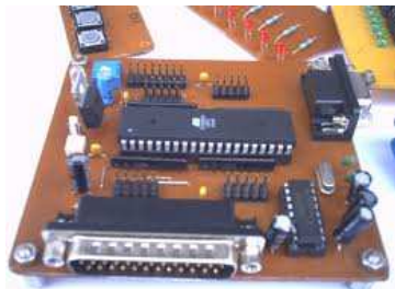
Gambar 11. Rangkaian mikrokontroller AT 89S51
