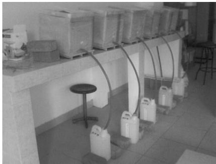
Gambar 1. Eksperimen, salah satu teknik pengujian kecepatan pencairan es di dalam kotak dengan dinding insulasi *polyurethane* yang memiliki kerapatan yang berbeda, yaitu  $\rho = 30, 35, 40, 45,$  dan  $50 \text{ kg/m}^3$ .
